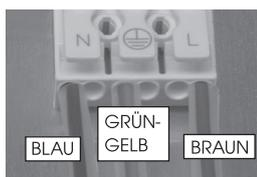
5. Schließen Sie daraufhin die drei Kabel an die vorgesehene Klemme in der Leuchte an. Dabei ist wichtig darauf zu achten, dass alle Kabel in die richtige Öffnung geklemmt werden.
